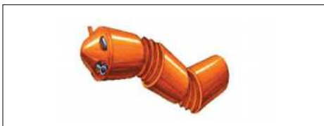
그림9. 인체 내에 삽입 가능한 캡슐형 MEMS 구동/센서 소자의 사례
