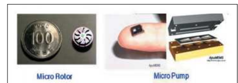
그림12. 기타 MEMS를 이용한 전지/모터/펌프 등의 초소형 구동소자
