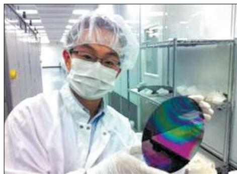
그림5. GaN on Si 기술을 이용한 8인치 LED용 에피 제품 (Bridgelux Inc.)
