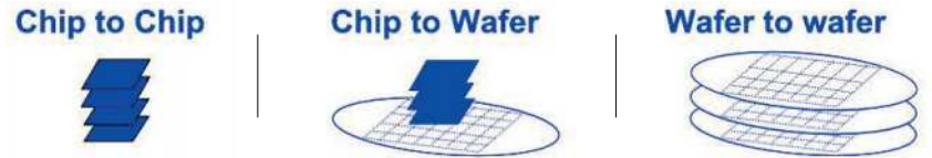
그림 9. 3D integration에 적용 중인 Wafer 적층 방식
